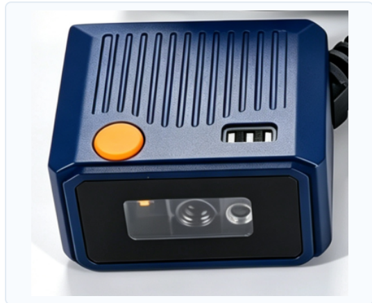
正面扫描窗口 + 橙色按键 + 状态指示灯 Front scan window, trigger button & LEDs
